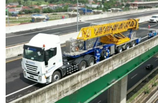
Penerapan IMS menggunakan hawk eye dan bridge inspection terintegrasi aplikasi.
