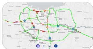
Jasamarga Integrated Digitalmap (JID) dashboard pemantauan kondisi lalin dengan parameter kecepatan, VC ratio, MIDAS s.d. proyeksi lalin
